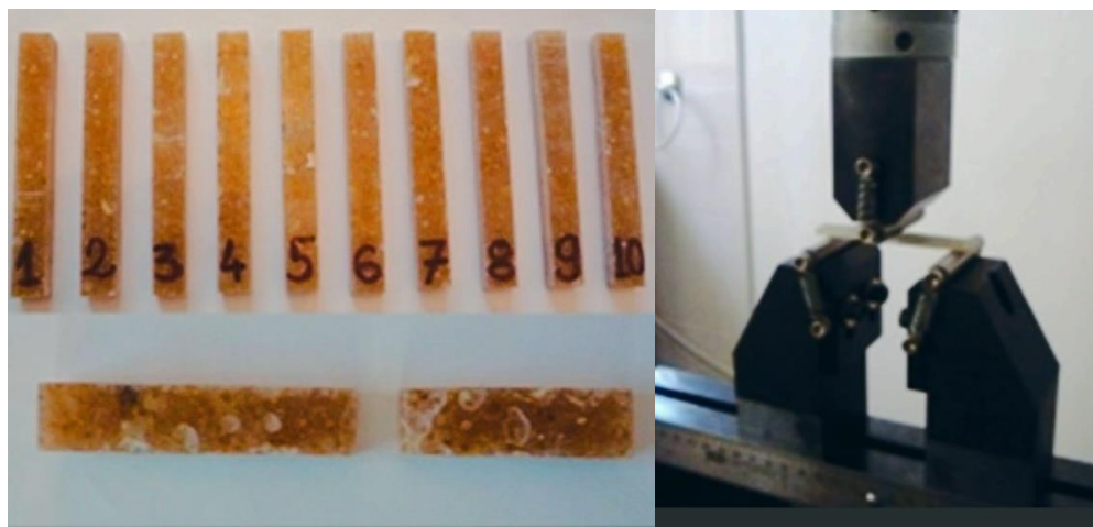
Рисунок 12 – Образцы стекловолокна а) перед испытанием на изгиб; б) после испытания на изгиб
