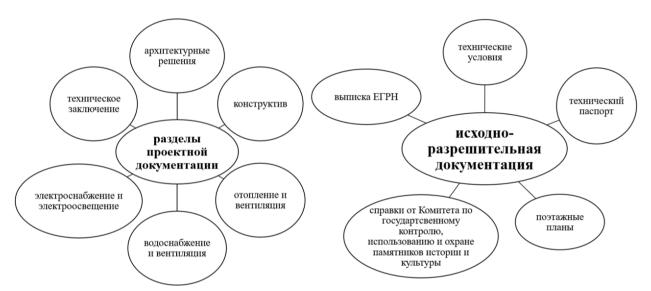
Рисунок 4. Разделы проектной и исходно-разрешительной документации
