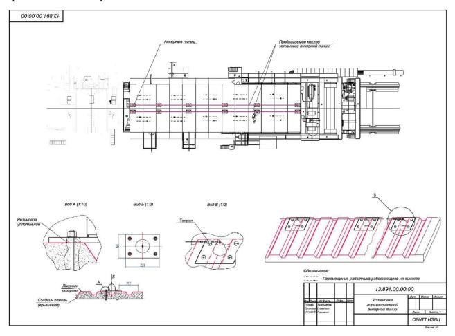
Рисунок 3 – Установка горизонтальной анкерной линии
