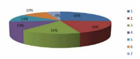
Рисунок 2 - Распределение несчастных случаев, произошедших на шахтах АО «СУЭК — Кузбасс» за период 2010 по 2019 г., по профессиям пострадавших: 1 — проходчик подземный; 2 — горнорабочий подземный; 3 — электрослесарь подземный; 4 — машинист горных выемочных машин; 5 — горнорабочий очистного забоя; 6 — водитель автомобиля; 7 — остальные виды профессий.
