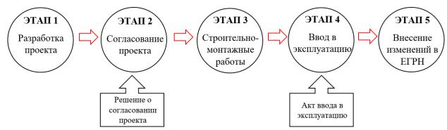
Рисунок 2. Этапы перепланировки и (или) переустройства
