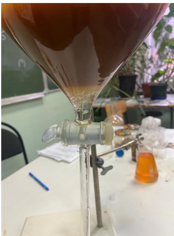
Рисунок 1 – Разделение фаз экстракта черного чая
