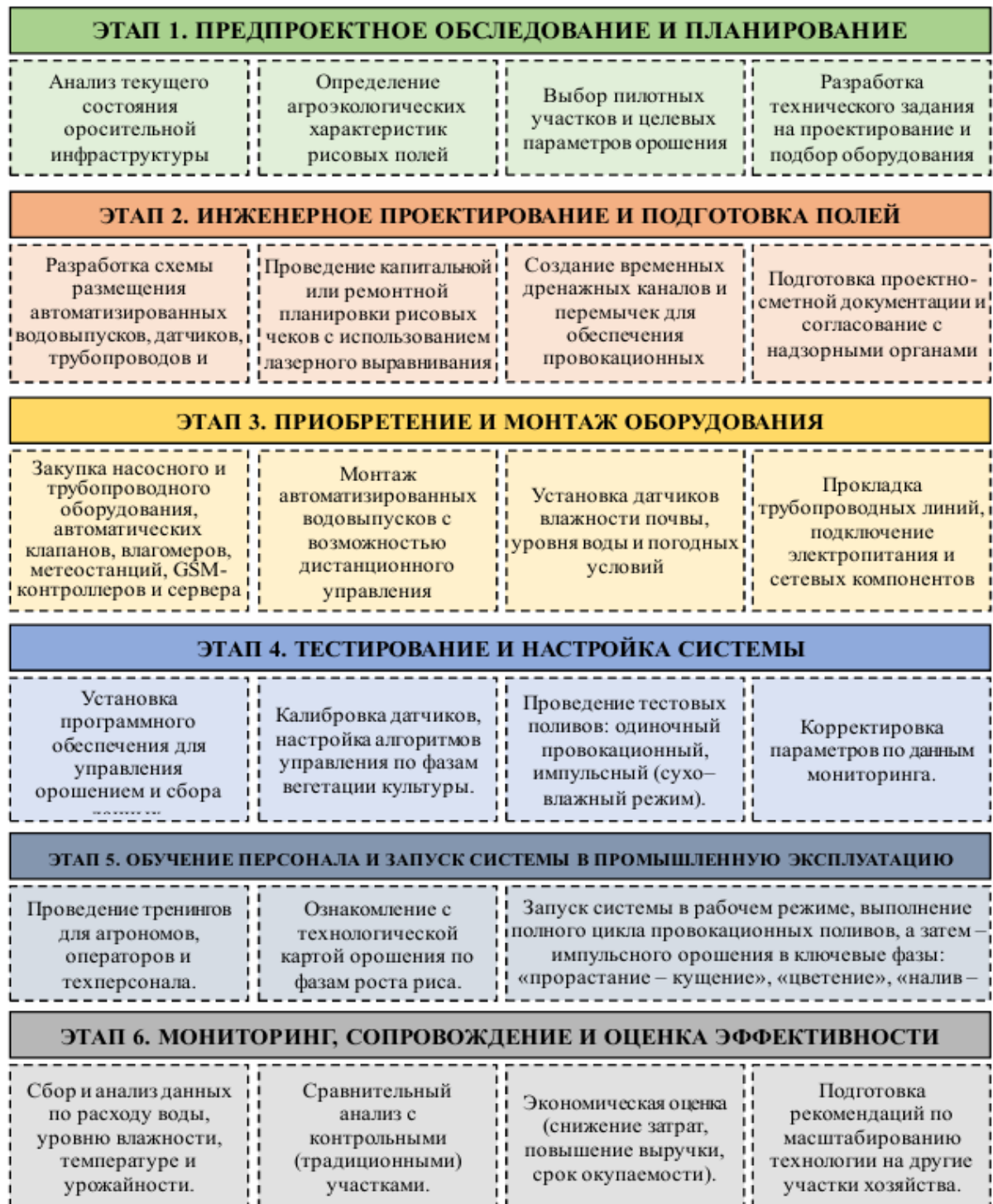
Рисунок 1 – Этапы внедрения автоматизированной системы орошения риса с элементами провocationsного и импульсного полива (разработано автором)
