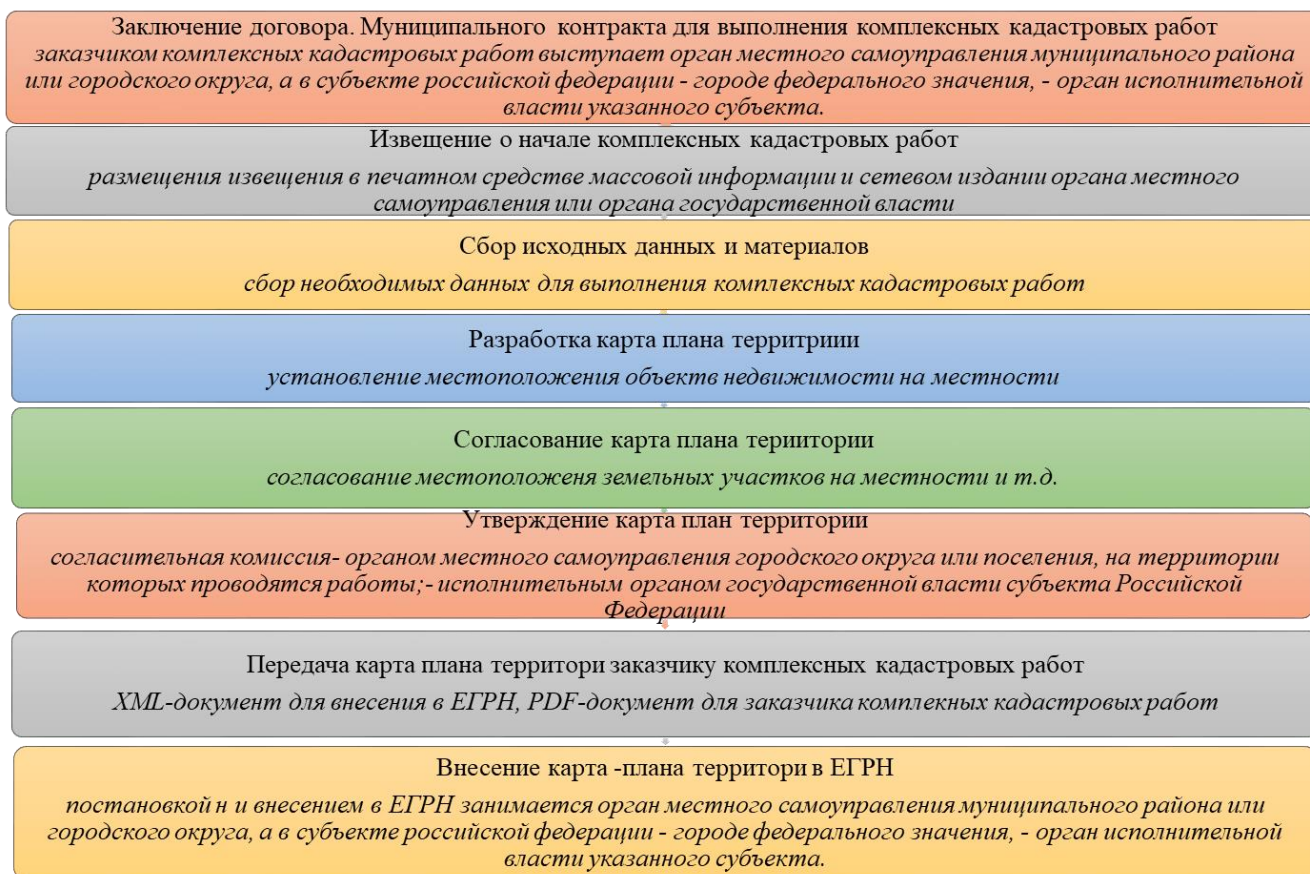
Рисунок 2 - Порядок выполнения комплексных кадастровых работ
