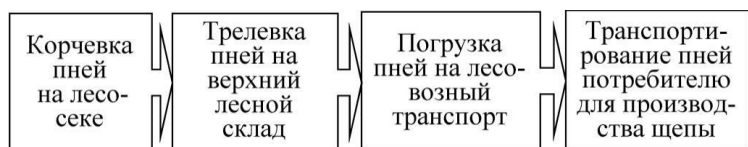
Рисунок 7 – Технологическая схема заготовки и измельчения пневмокорневой древесины в щепу
